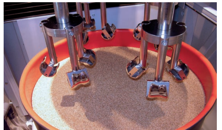
Die Werkstücke werden auf Werkstückhaltern befestigt. Je nach Abmessung und Form können sich gleichzeitig mehrere auf einer Halterung befinden. Abhängig von der Maschinengröße und der Arbeitsspindelanzahl sind beispielsweise bei Knieimplantaten (Femur) zwischen 12 und 28 Bauteile in Bearbeitung.
