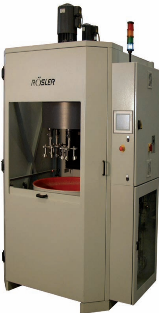
Die kompakten Schleppfinish-Anlagen lassen sich durch ihre Plug-and-Play-Konzeption einfach und kostengünstig in bestehende Fertigungen integrieren.
