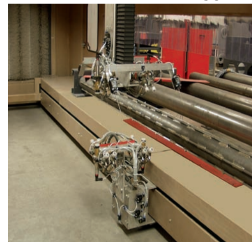
Zwei Lackierkreise mit jeweils acht Spritzdüsen (je 4 zur Lackapplikation von Ober- und Unterseite) ermöglichen das gleichzeitige Auftragen von rotem und grauem Schweißprimer auf die Bleche und Profile.
