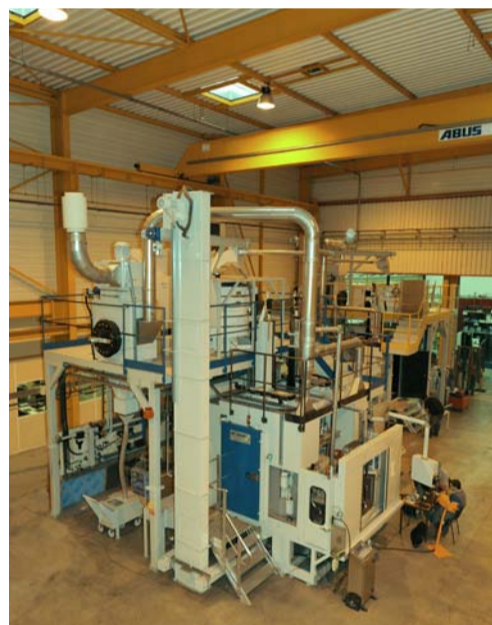
Die Shotpeening-Anlage mit fünf Arbeitsstationen und jeweils zwei Satelliten ermöglicht das gleichzeitige Oberflächenverdichten verschiedener Getriebeteile mit zwei unterschiedlichen Strahlmitteln.
