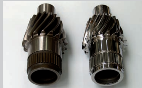
Beim Gleitschleifen von großen Getriebe- und Lagerteilen werden Rauigkeitswerte von Ra 0,02 µm erreicht.
