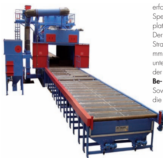
Das Strahlssystem RRBK 25/21 wurde für die Bearbeitung von bis zu 16.000 x 2.500 x 2.100 mm großen, dreidimensionalen Schweißkonstruktionen sowie Blechen mit einer minimalen Höhe von 3 mm ausgelegt.
