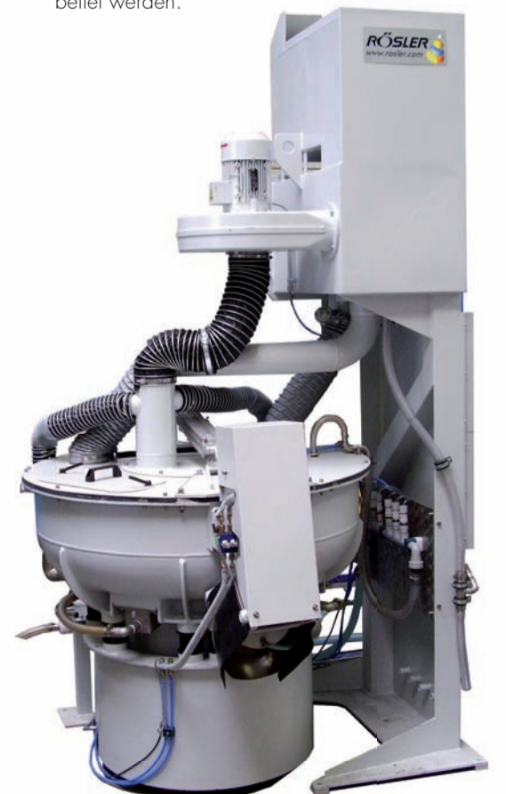
Die neue WTA ermöglicht die automatische Bearbeitung von Miniatur- und Kleinteilen entsprechend einem programmierten Prozessablauf.
