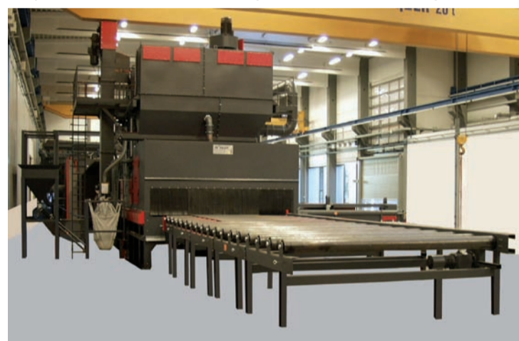
In der vollautomatisierten Konservierungslinie werden Bleche mit Abmessungen von maximal 20.000 x 3.500 x 50 mm (LxBxH) und bis 600 mm hohe Profile gestrahlt und anschließend mit einer Primerschicht überzogen.
